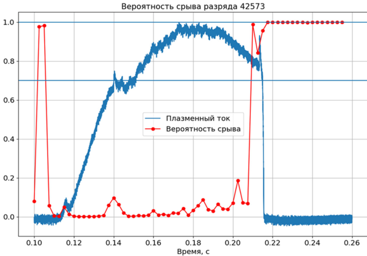
Рис.6 Вероятность срыва для разряда #42573 (график слева) и #40096 (график справа) для модели многослойного перцептрона
